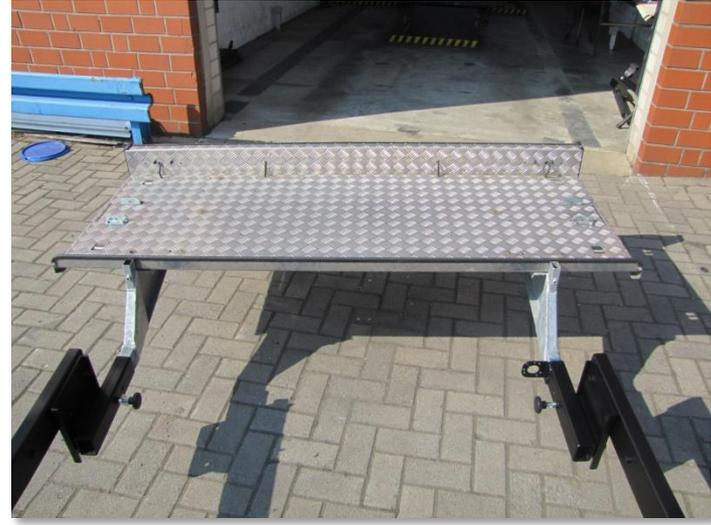
2. Durch die vorgebohrten Löcher im Grundträger auf beiden Seiten die Position der Plattform markieren
