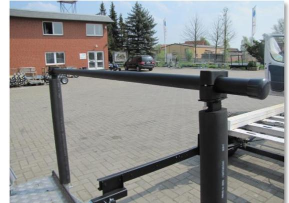
2. Hauptholm mittig ausrichten und die Rohrschellen festziehen
